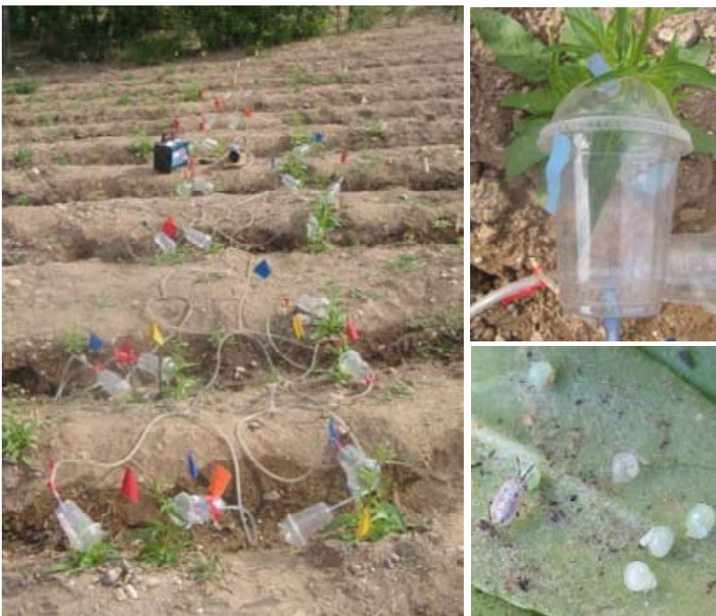
Figur 9. Feltforsøg med naturstoffer og insekter. Tobaksplanterne forsynes med beholdere, hvor der skabes undertryk ved hjælp af en pumpe. De flygtige stoffer som udskilles fra bladene opfanges af et filter, så mængde og sammensætning af stofferne siden kan bestemmes i laboratoriet. Foto: Cp. Gowda Rayapuram.
