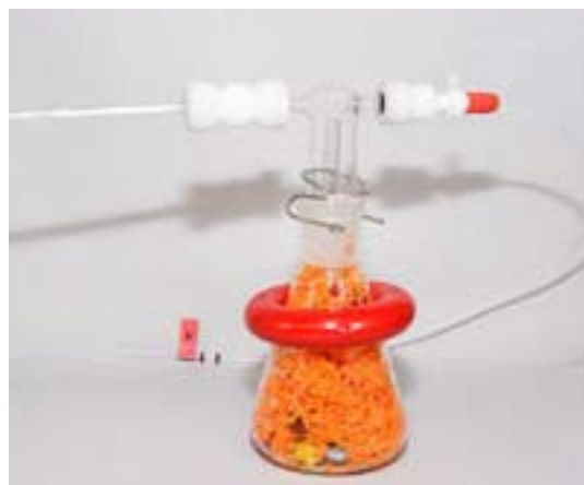
Figur 2. Forsøgsopstilling til dynamisk headspace-opsamling.
