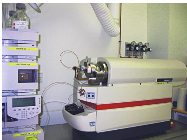
Figur 7. Apparatur til LC-MS/MS analyse. LC-apparatet til venstre adskiller de enkelte toksiner, mens MS/MS-detektoren til højre måler koncentrationen af stofferne. Foto Niels Henrik Spliid.
