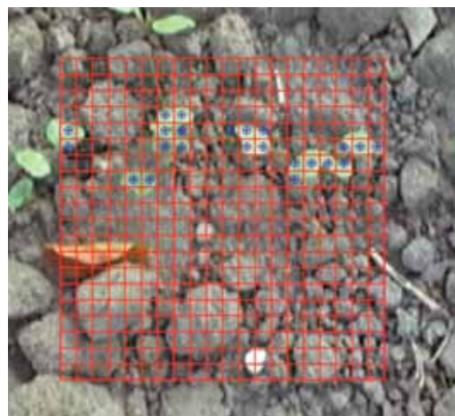
Figur 3. Figuren viser, hvordan visionsystemet holder styr på placeringen af ukrudtet. Celler, som indeholder mindst 50 pct. ukrudtsplanter, afmærkes (de blå prikker) til sprøjtning. Cellerne er 25 x 25 mm.
